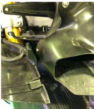
純正カウルとRC用フルカウルとは製品の分割方法が異なるため、カウルインナーとラムダクト部分を固定してしまうとRC用フルカウルの取り付けが非常に困難になる為にボルトで固定せずフリーの状態でご使用ください。ボルトで固定してなくても、走行に支障はございません。
