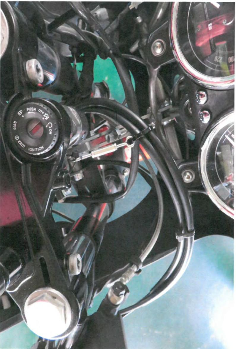
スロットルケーブルの取り回しは付属のステーとタイラップを使用して取り付けてください。
