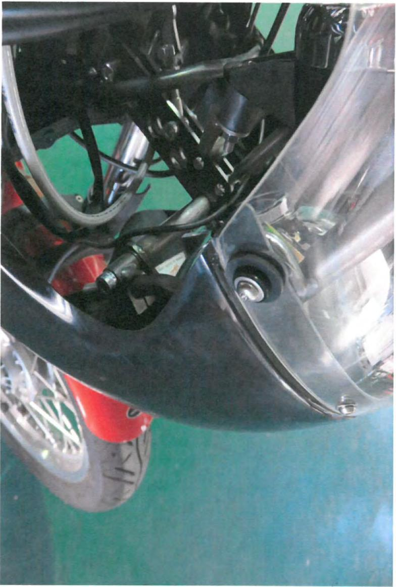
スクリーン取りつけボルト(後端左右)のゴムワッシャーはスクリーンとカウルングの間とスクリーンの外側の両方に取り付けてください。
