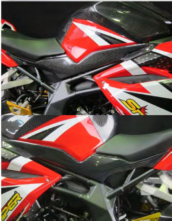
※FRP・カーボン製品の特性上、収縮によりボルト穴位置がずれることがあります。この場合、ヤスリ等で穴位置を修正してから取り付けてください。
