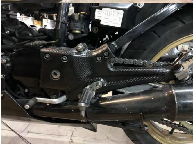
※FRP・カーボン製品の特性上、収縮によりボルト穴位置がずれることがあります。この場合、ヤスリ等で穴位置を修正してから取り付けてください。
