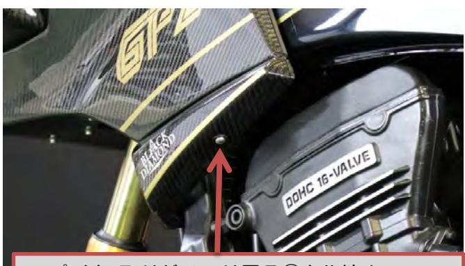
アッパー・カウル取付ボルトに付属品①を共締めし、付属品①に④を取り付け②③にてハーフサイド・カウルを取り付ける
