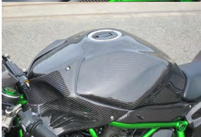
※FRP・カーボン製品の特性上、収縮によりボルト穴位置がずれることがあります。この場合、ヤスリ等で穴位置を修正してから取り付けてください。
