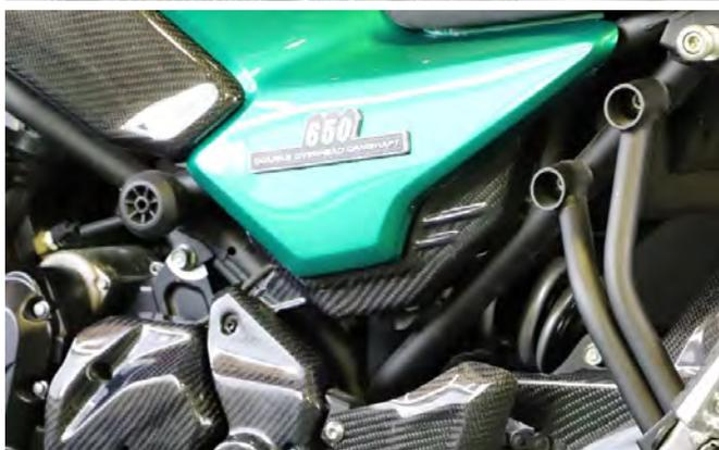
※FRP・カーボン製品の特性上、収縮によりボルト穴位置がずれることがあります。この場合、ヤスリ等で穴位置を修正してから取り付けてください。
