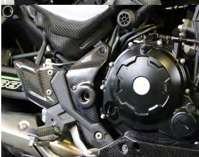
※FRP・カーボン製品の特性上、収縮によりボルト穴位置がずれることがあります。この場合、ヤスリ等で穴位置を修正してから取り付けてください。
