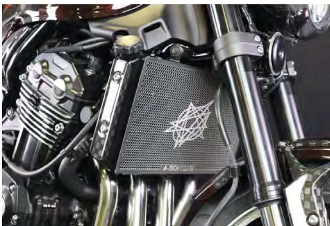
※取付の際に車体のボルトを利用するコアガードの場合、締め付けトルクはサービスマニュアルを参照のうえ締めつけてください。
