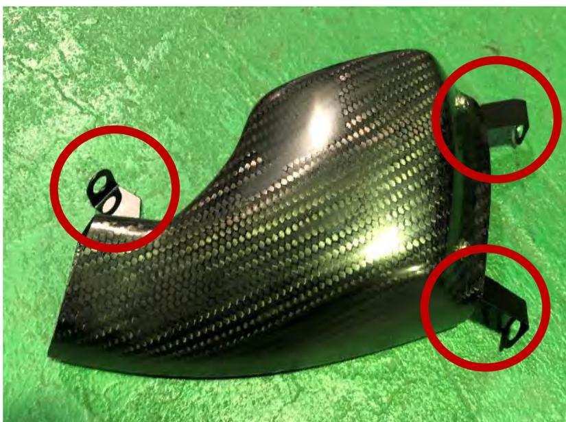
取り付けステーは左右とも製品側3カ所に仮付けしてから車両側にセット組付けした方が作業が容易に行えます。各ボルト類は1か所だけ本締めせずに、各ボルトを調整しながら少しずつ締め付け、最後にすべてのボルトを本締めして下さい。
