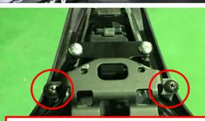
シートカウル本体取り付け前に、ここの2箇所の 純正ボルトを必ず取り外してください。 ボルトが付いたままですと、シートカウル本体が 車体に装着不可となります。
