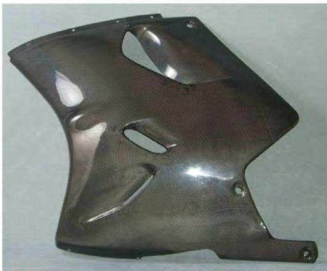
※FRP・カーボン製品の特性上、収縮によりボルト穴位置がずれることがあります。この場合、ヤスリ等で穴位置を修正してから取り付けてください。
